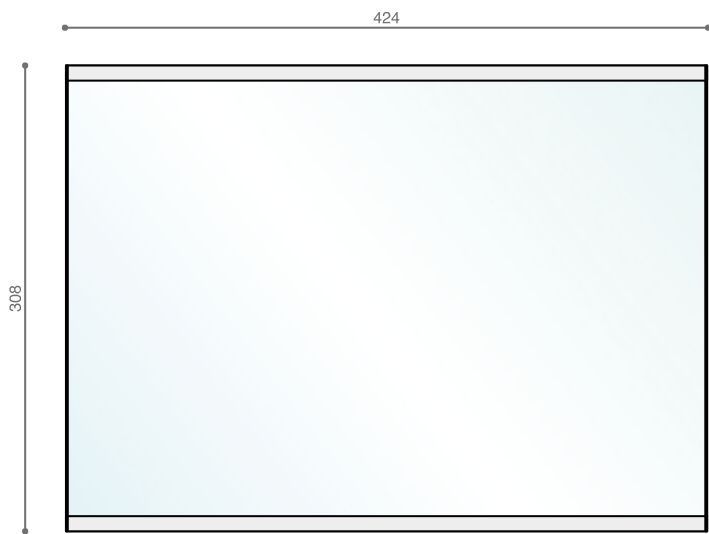
■書架サイン(A3ヨコ紙差し) 44-025 仕様:ペーパーカバー/アクリル(透明、ケンドン式) フレーム/アルミ(アルマイト処理)
